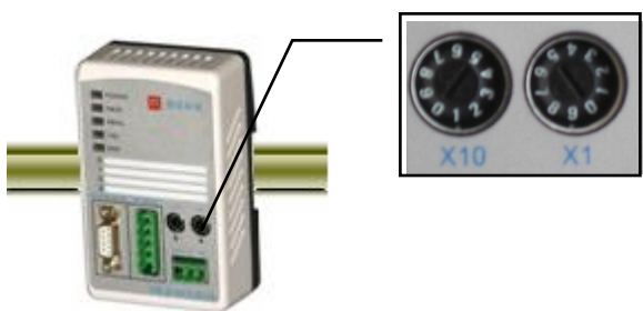
图 2-13 PROFIBUS 从站地址设置开关 SA，地址设为 19
